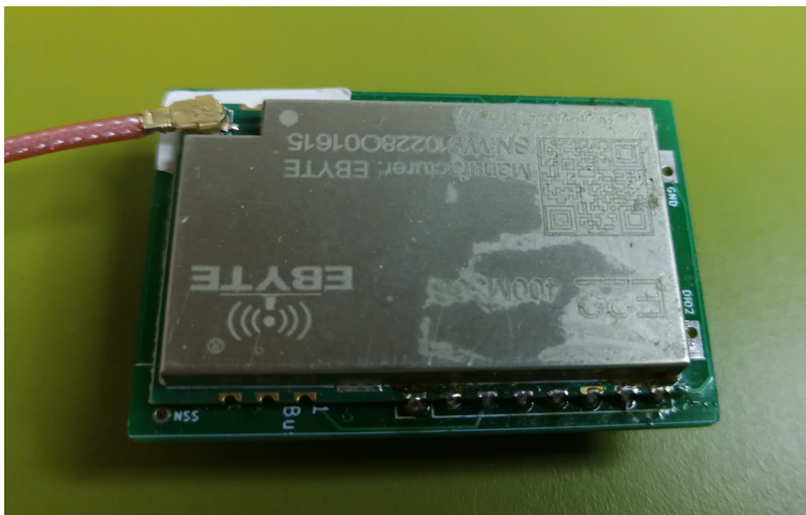
Figura 16 LoRa carrier : LoRa module montato su relativo PCB carrier
