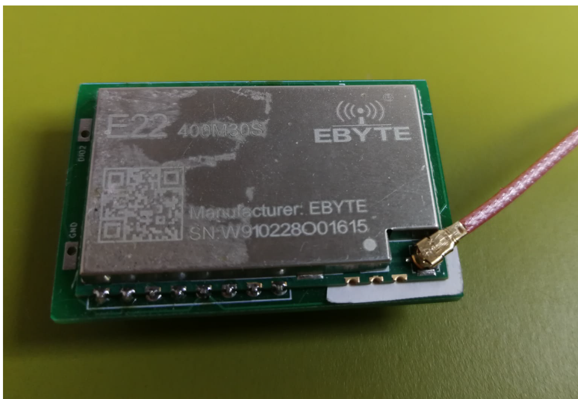
Figura 17 LoRa carrier : LoRa module montato su relativo PCB carrier
