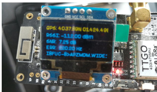
Figura 58 Esempio Display TTGO T-Beam
