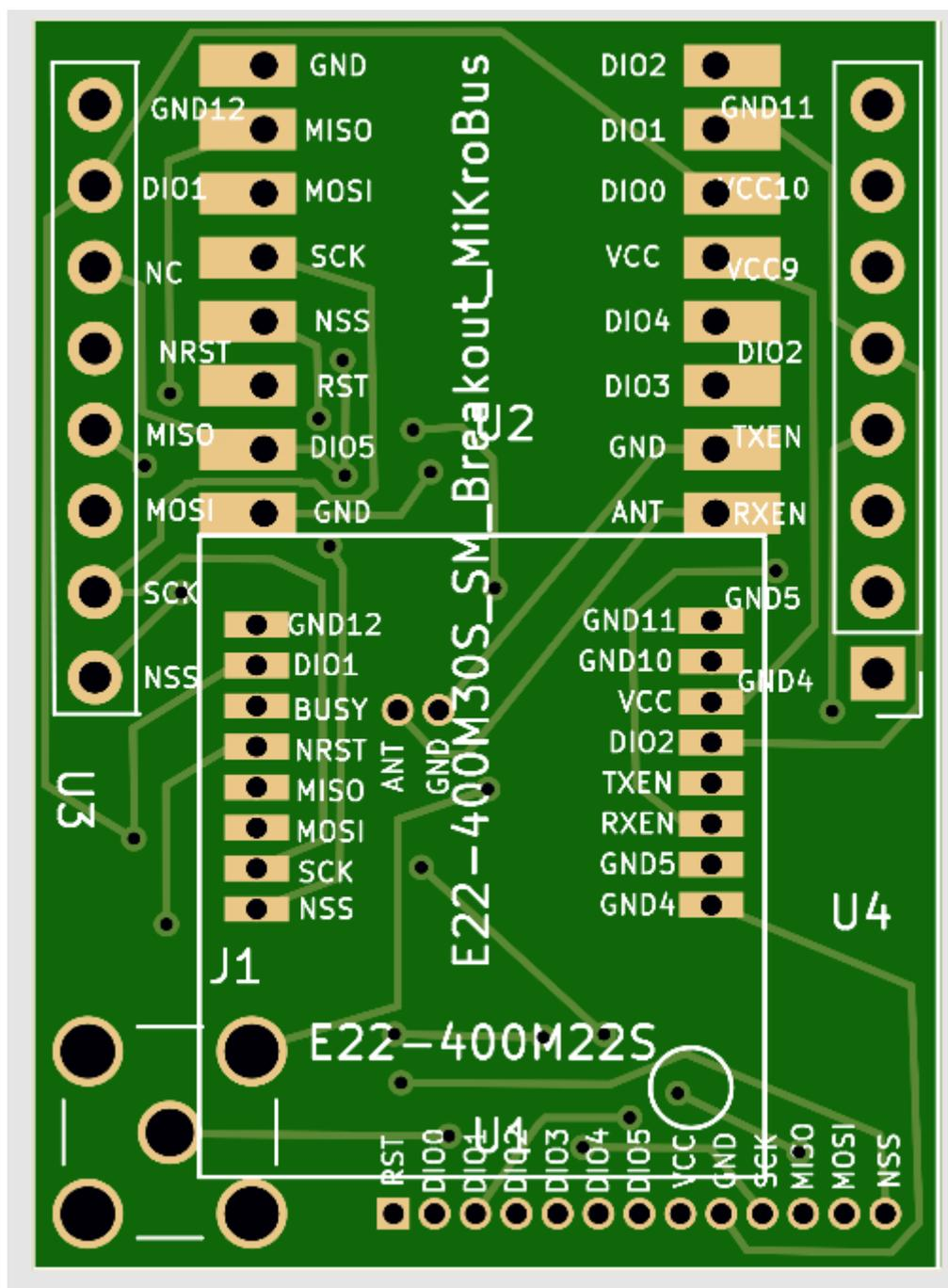
Figura 15 LoRa\_Carrier : vista superiore del PCB
