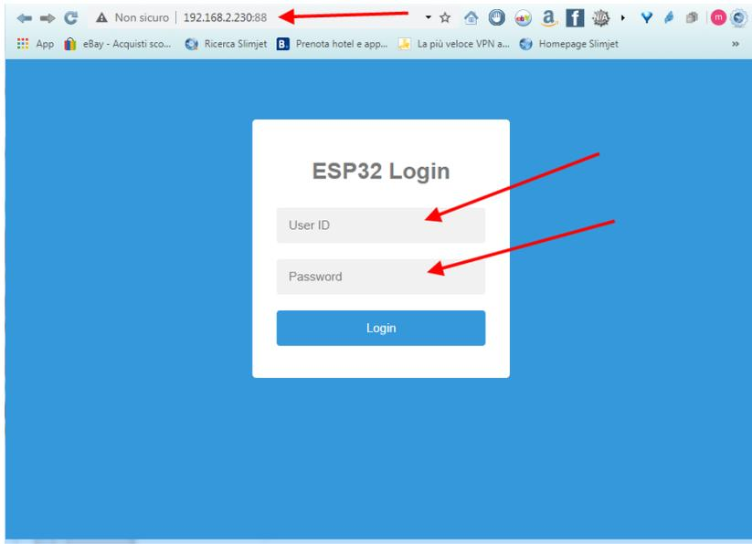
**Figura 62** Interfaccia per caricamento SW via OTA
