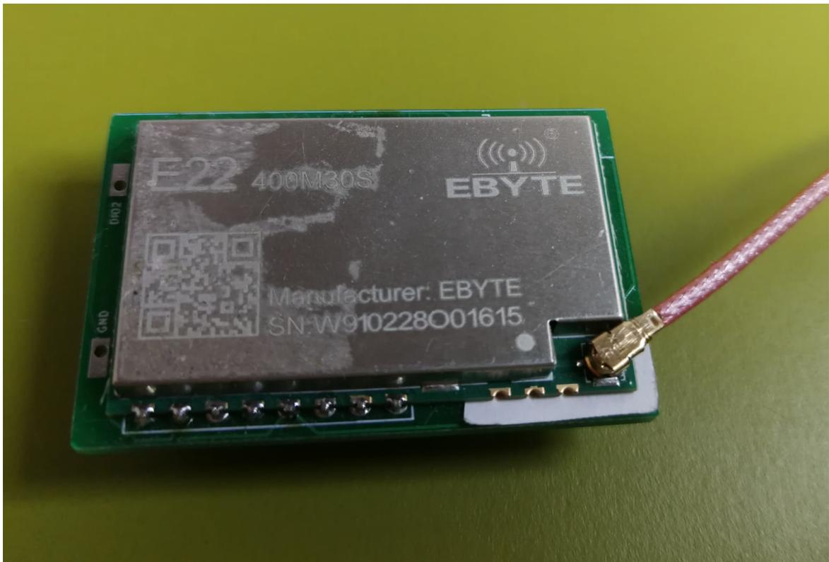
**Figura 17 LoRa carrier : LoRa module montato su relativo PCB carrier**
