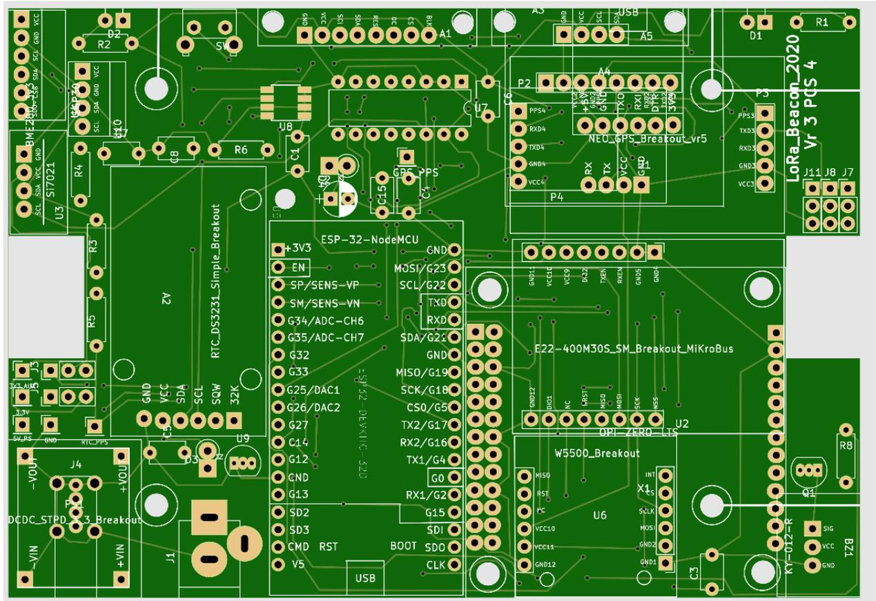
Figura 12 . LoRa\_Beacon\_Vr 3 pcs 4 : foto lato superiore PCB
