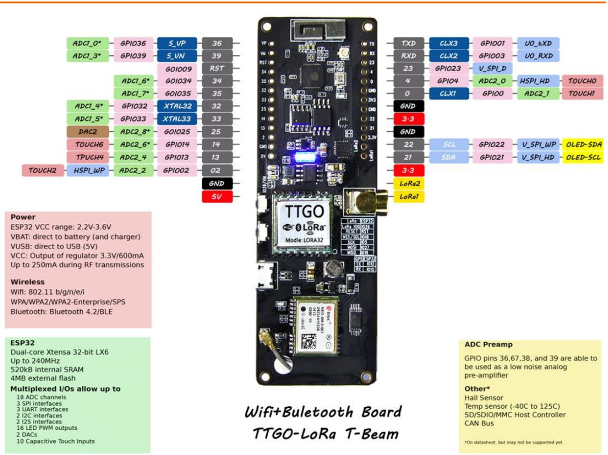
Figura 52 Dispositivo TTGO T-Beam V1 utilizzato per il test
