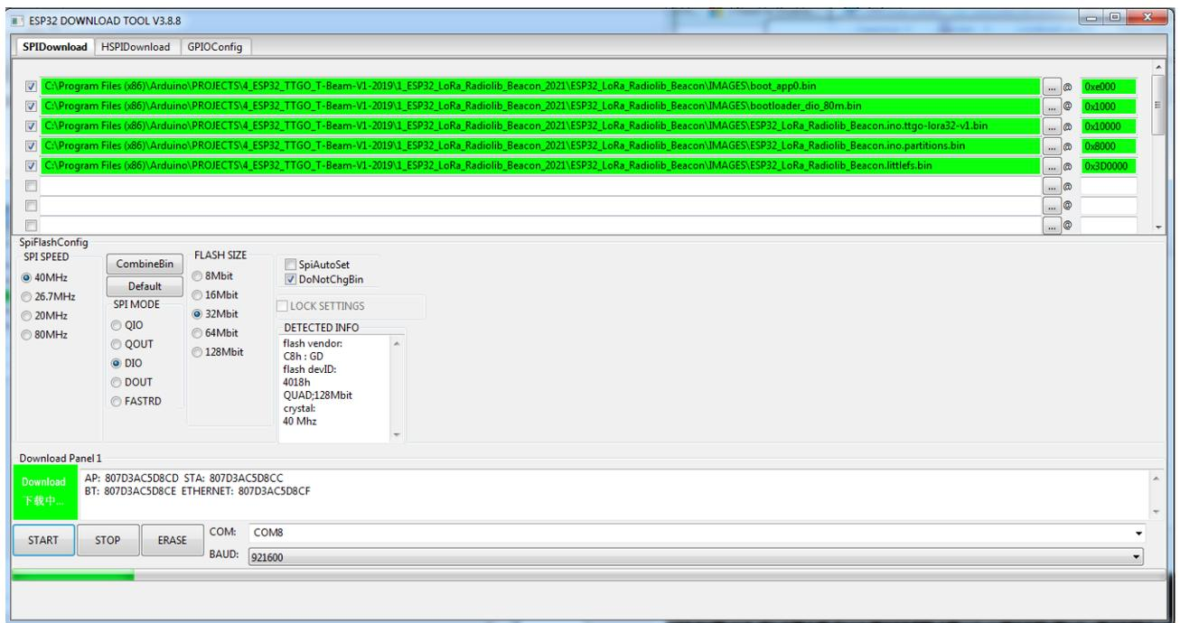
Figura 54 Settaggi da usare per il download del SW su TTGO T-Beam V1
