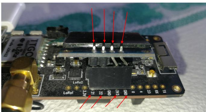
Figura 53 Collegamento Display I2C
